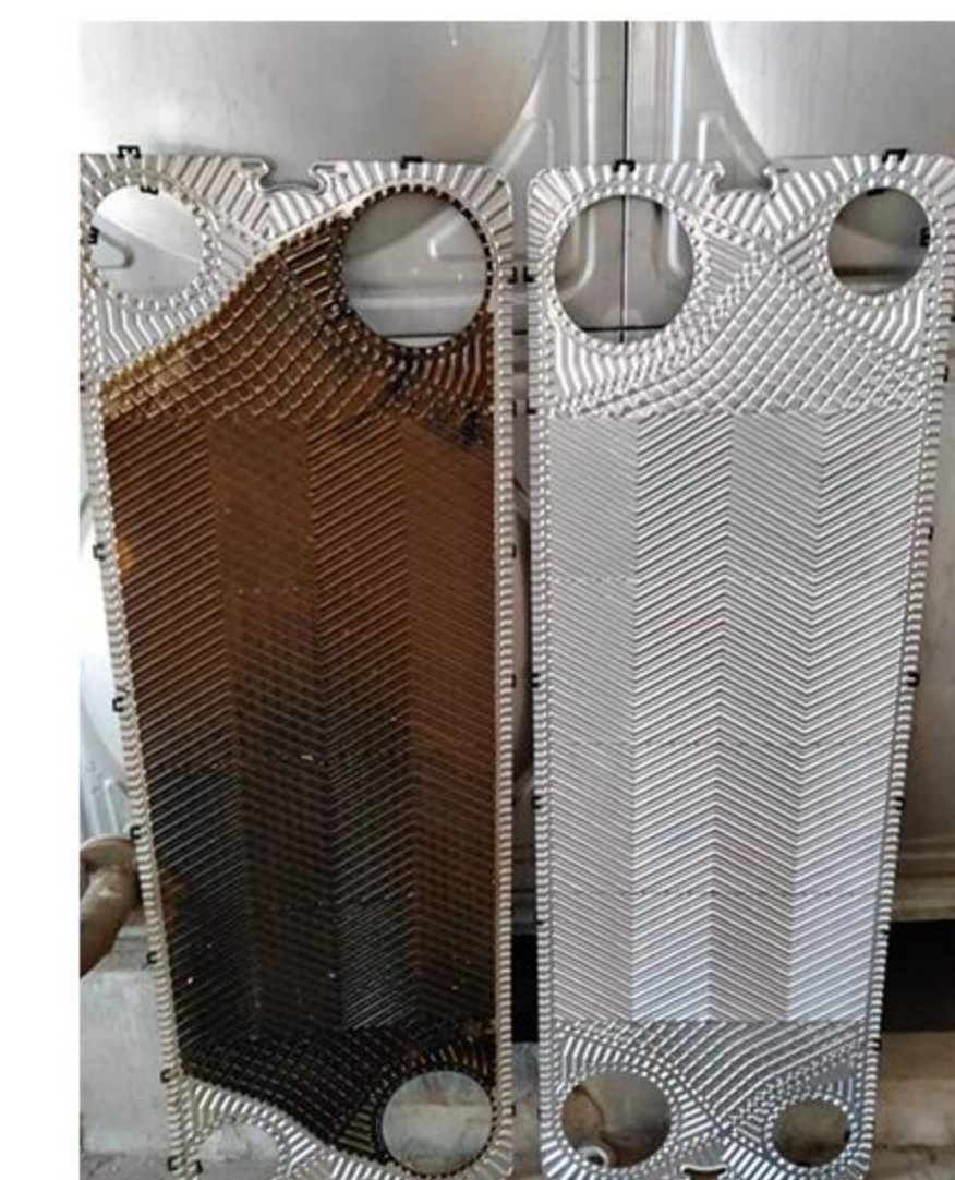
二级换热站清洗后
